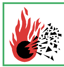
Thermique ou pouvant provoquer un incendie ou une explosion
